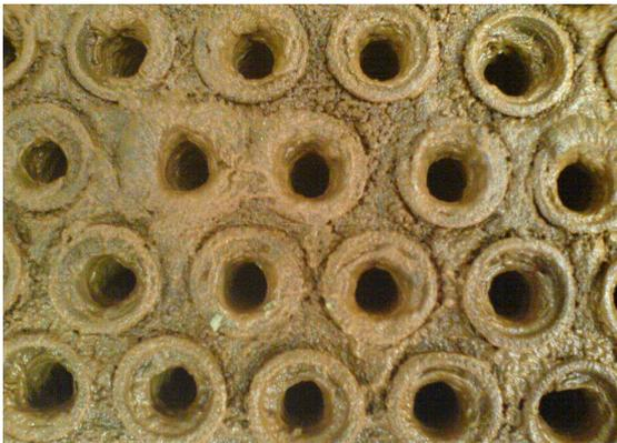
*Наглядный пример образования отложений. Один из самых тяжелых случаев загрязнения трубного пучка накипью, твердой окалиной и ржавчиной.*
